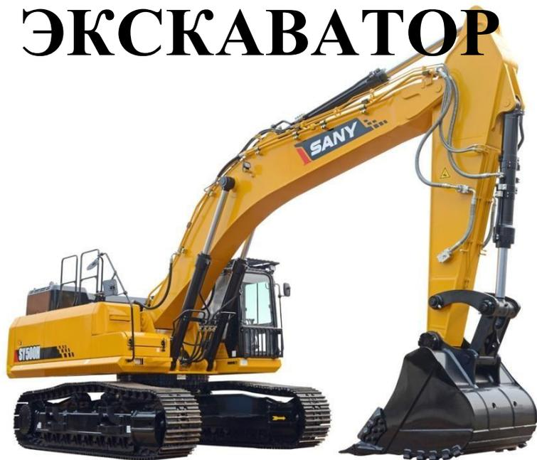
Рабочий вес 50 500 кг      Мощность 300 кВт      Ковш 2.2~3.1 м<sup>3</sup>
